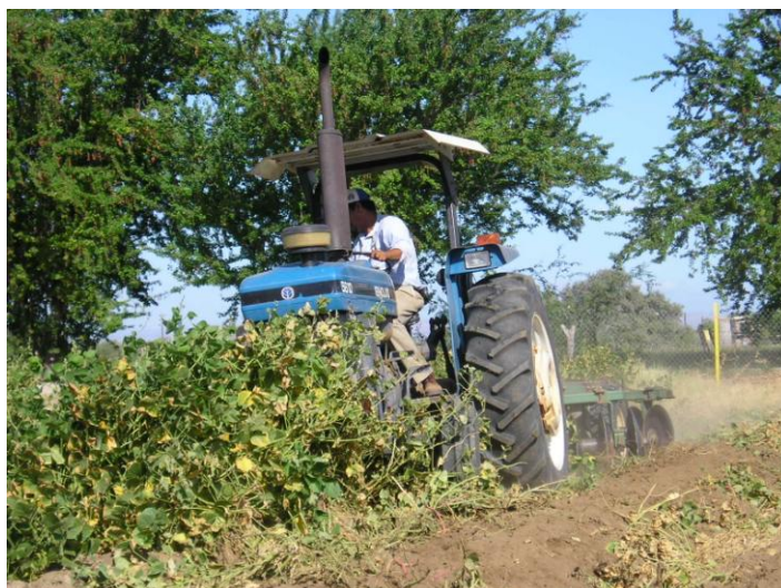
Figura. 2. Incorporación de frijol dolichos con rastra de discos (Beltrán, 2005).
