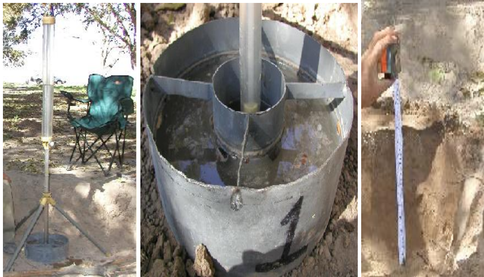
Figura 9. Método de Müntz modificado para medir permeabilidad.
