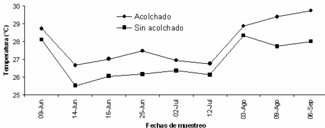
Figura 3. Temperatura del suelo con y sin acolchado en el cultivo de tomate a la profundidad de 0-15 cm en el CAE-FAZ-UJED, 1999.
