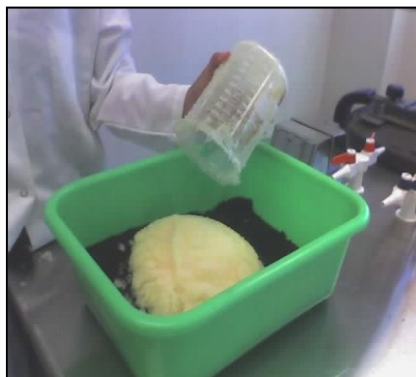
Foto 1. Preparación de la mezcla de resinas de intercambio iónico (cationica y anionica)
